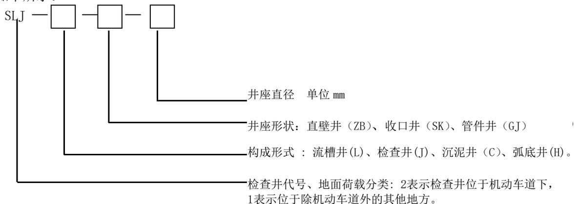
示例 1: 与外径标识的管道连接的井座、位于机动车道下, 有流槽, 直壁井, 井座外径 OD315mm, 标记为 SLJ2-L-ZB-OD315。
