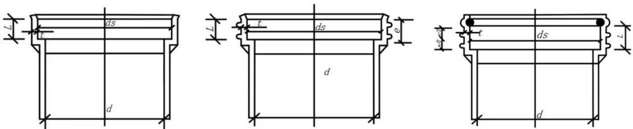
图3 井座与井筒连接承口示意图
