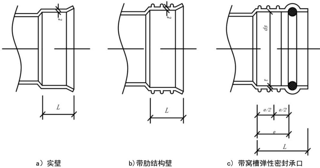
图4 井座与管道连接承口示意图
